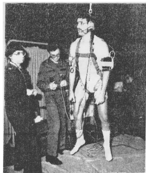
写真3 フルハーネスによる吊り下げ状態 5)
